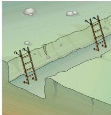
Figura 2 – Instalação de escadas em escavação de vala com mais de 1,25 m de altura
