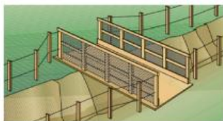
Figura 5 – Passarela em escavação para circulação de pessoas
